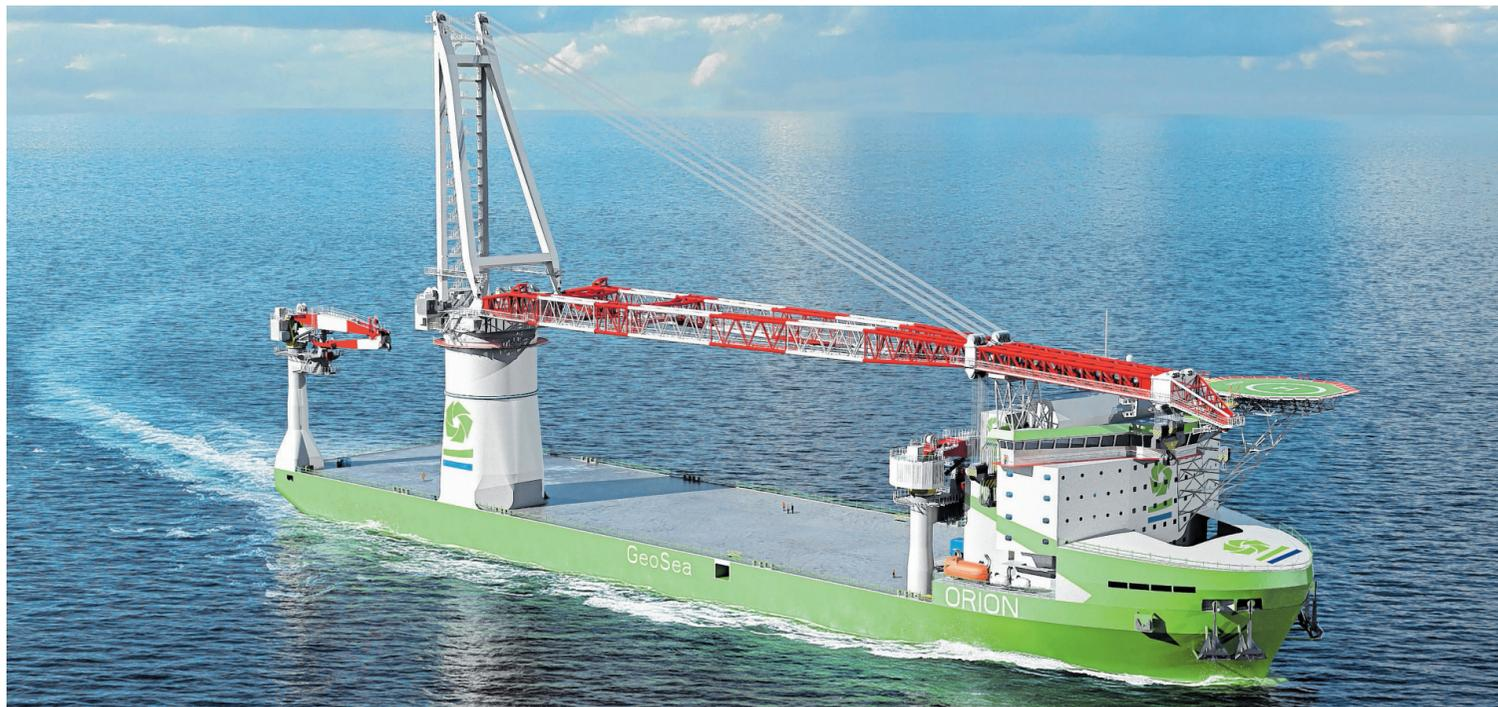
Das Spezialschiff „Orion“ bekommt einen Schwerlastkran, der 3000 Tonnen heben kann.
